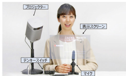
区役所窓口で実証実験を行い上市した、話された言葉を表示する「わかりやすい字幕表示システム」cotopad(コトパッド) 〔京セラ株式会社〕
