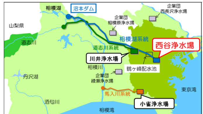
図 1 水源系統と浄水場
