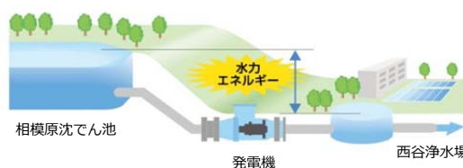
小水力発電イメージ（川井浄水場）
